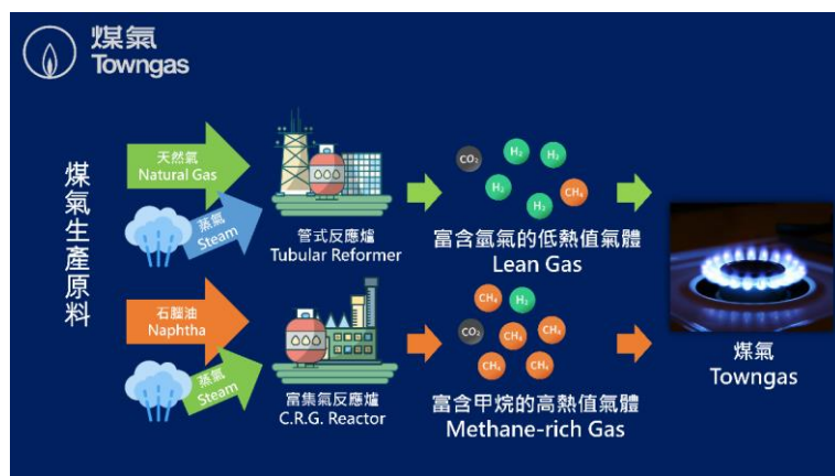
上圖:煤氣的生產過程: 經過氣化及高溫蒸氣混合產生反應，當中的部分甲烷會被重整成氫氣及二氧化碳。因此，煤氣成份當中約有一半是氫氣。
